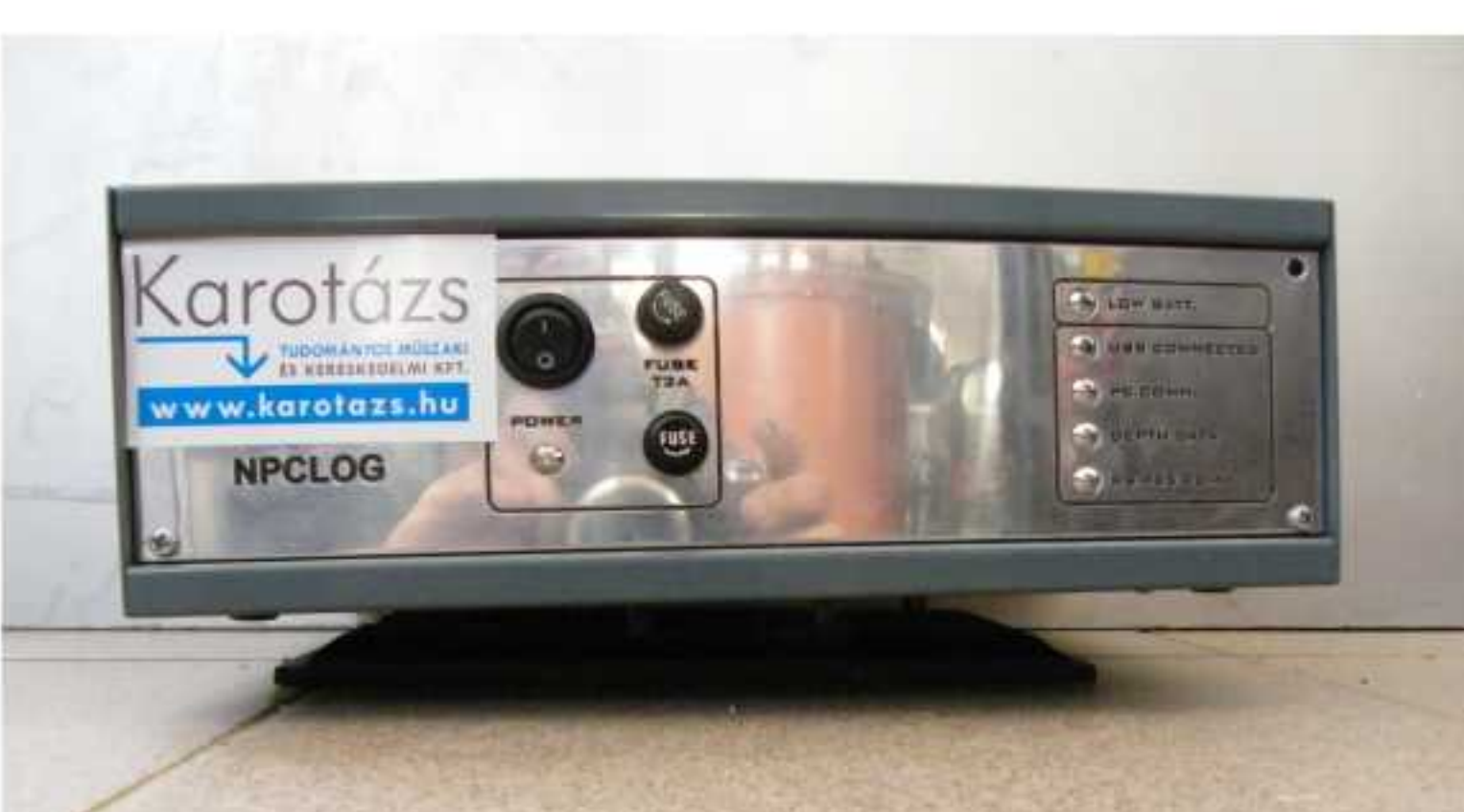
Az NPCLOG felszíni adatgyűjtő egység
