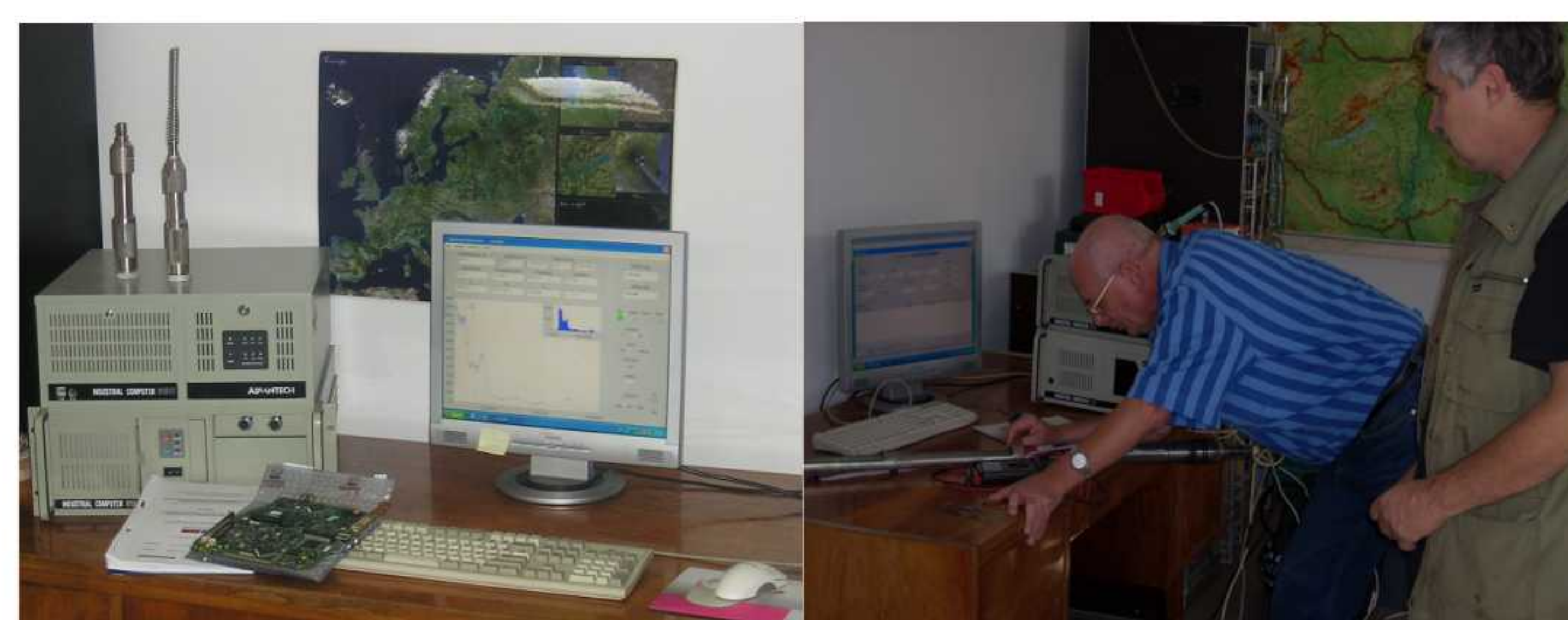
Ffelszíni mérőegység ipari számítógép-házban elhelyezve, illetve a mérőszonda elektronikájának tesztelése
