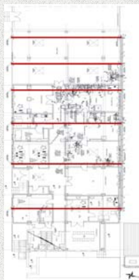
Az épület alaprajza, jelölve a dréncsöveket
