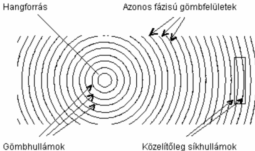
3.1 ábra: A térben kialakuló rezgéstér (gömbhullámok) pontforrás esetében
