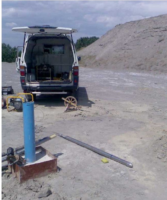
4.3. ábra: Mérési előkészületek a Bánhidai Erőmű zagyterén, a Bhz-1 megfigyelőkút környezetében
