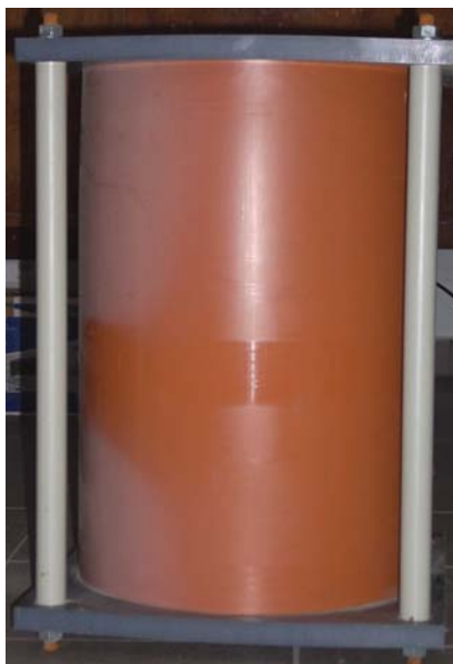
3.1. ábra: A mérőrendszer kalibrálásához használt etalon-modell
